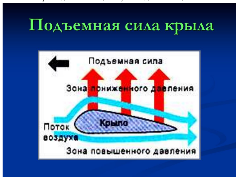
Схема 2. Почему крыло создаёт подъёмную силу
